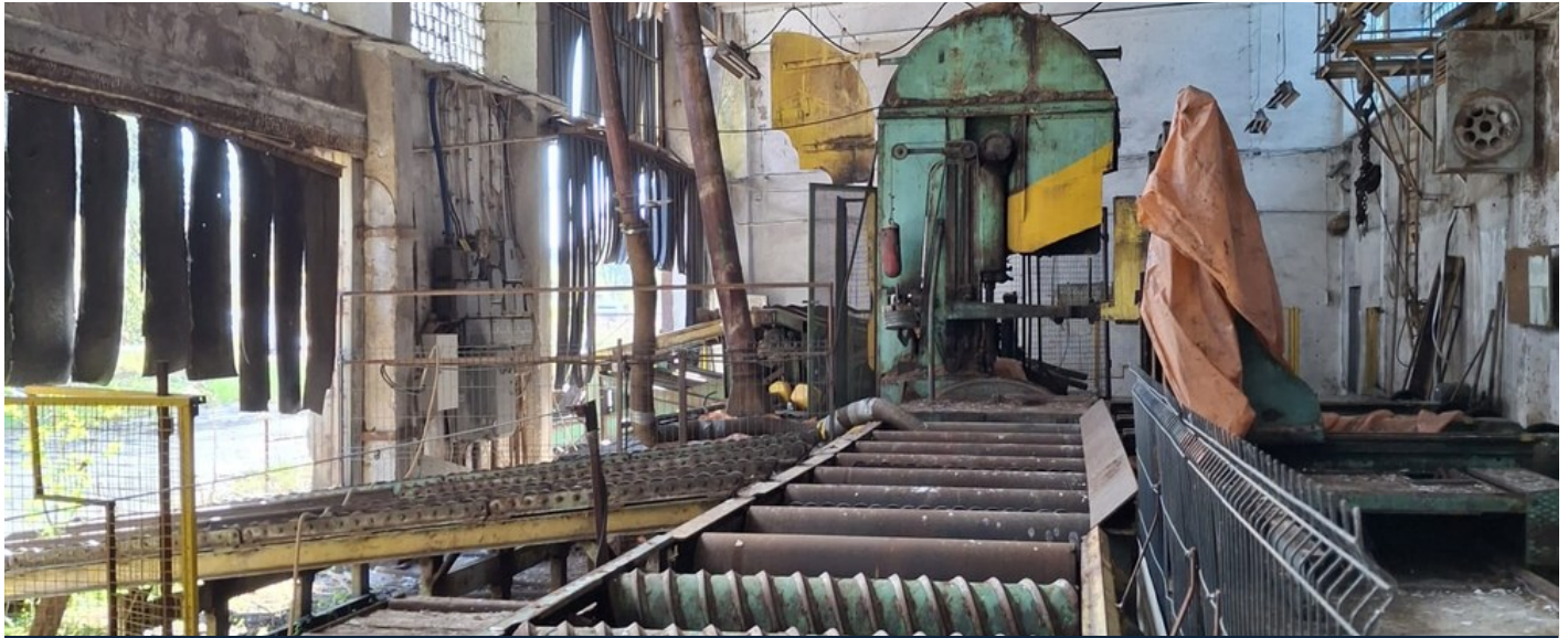
Pionowy trak taśmowy z transportem wejściowym i odbiorczym
